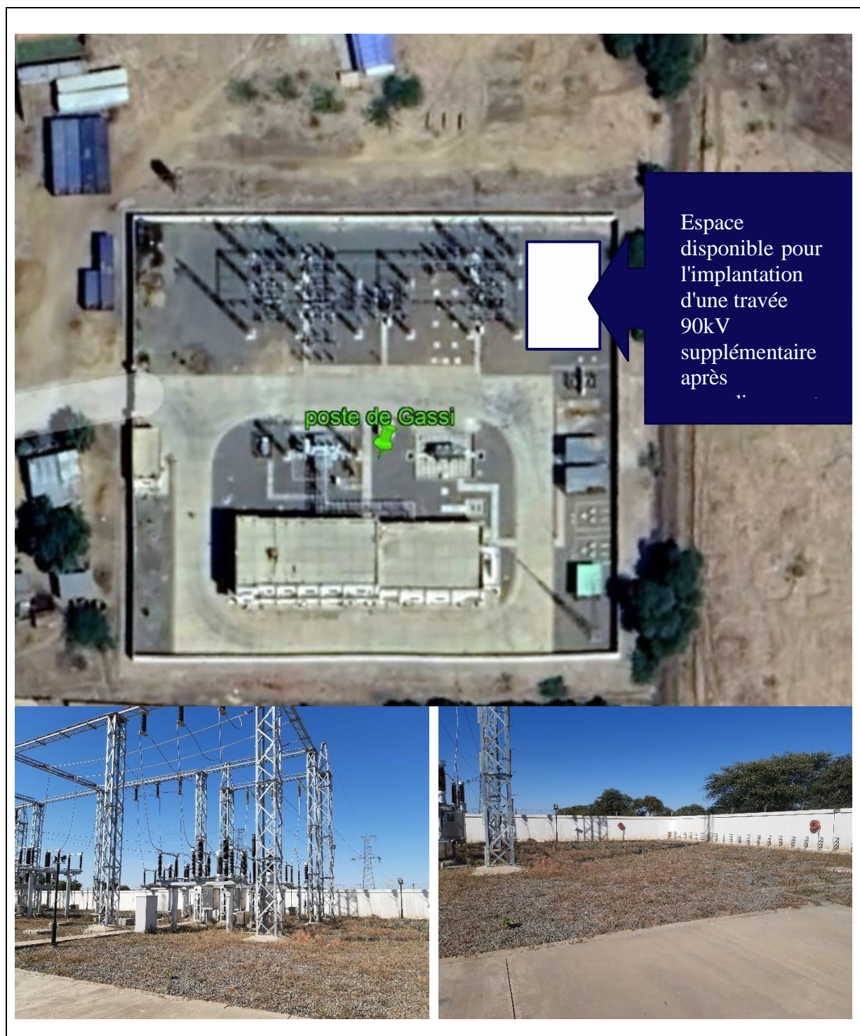
Figure 3 : Implantation d'une travée 90kV supplémentaire
